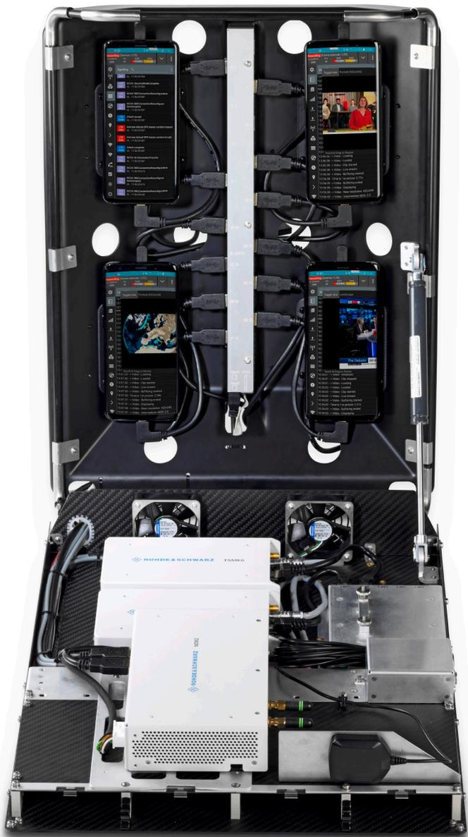
Вид изнутри с установленными телефонами QualiPoc, встроенным компактным ПК R&S®NCM2 и сверхкомпактным сканером R&S®TSME6 для измерения покрытия сети
